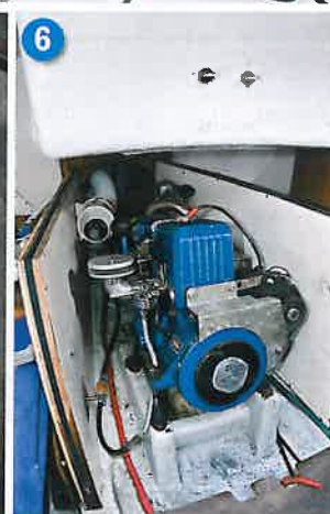
Knackpunkte, die vor dem Kauf der Eygthene überprüft werden sollten: Durch Regatta-Einsatz kann das Balsa-Sandwichdeck weich, gerade an Belastungszonen wie dem Mastfuß kann der Holzkern verrottet sein (4); dieses altersschwache Ventil muss getauscht werden (5), der Vire-Benzin-Innenborder sollte mit einer Zwangsbelüftung nachgerüstet sein (6)
