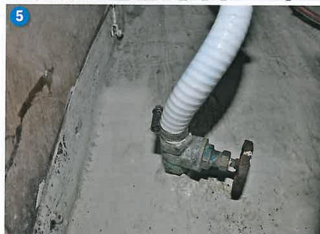
Knackpunkte, die vor dem Kauf der Eygthene überprüft werden sollten: Durch Regatta-Einsatz kann das Balsa-Sandwichdeck weich, gerade an Belastungszonen wie dem Mastfuß kann der Holzkern verrottet sein (4); dieses altersschwache Ventil muss getauscht werden (5), der Vire-Benzin-Innenborder sollte mit einer Zwangsbelüftung nachgerüstet sein (6)
