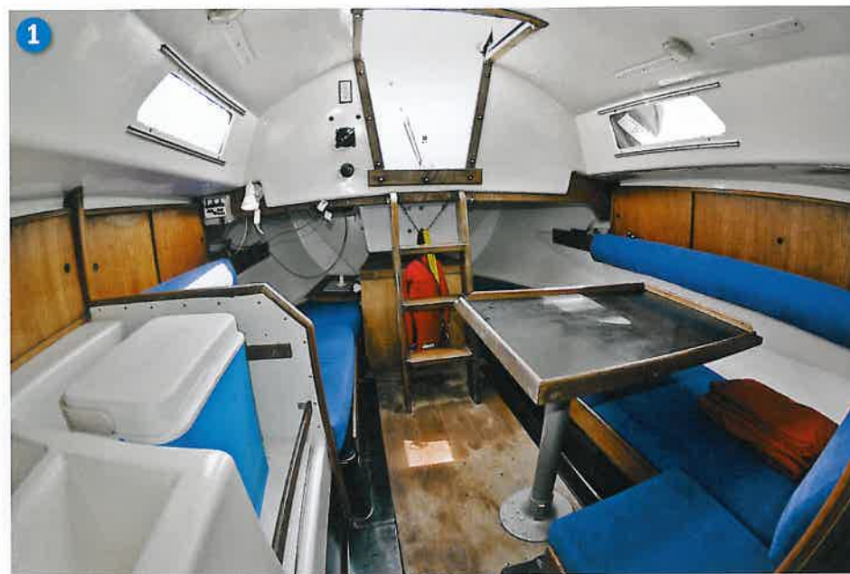
Der voluminöse IOR-Bauch sorgt auf der Eygthene unter Deck für ein wahres Raumwunder (1): zwei Hundekojen, V-Koje, WC und Pantry mit Zweiflammenherd sowie ein Esstisch und diverse Staumöglichkeiten konnten verbaut werden. Der Ausbau ist einfach, aber solide. Die Elektrik ist veraltet (2). An den Fenstern kommt es zu Spannungsrissen und in der Folge zu Leckagen (3)
